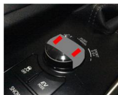
ビニールテープ及び両面テープ貼付例
